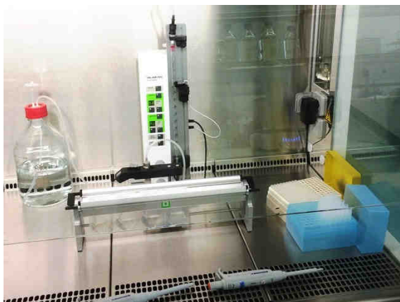
Bild 1: Inlabtec Serial Diluter in der Sterilbank des ISO / IEC 17025 akkreditierten und GMP-konformen Prüflabors.
